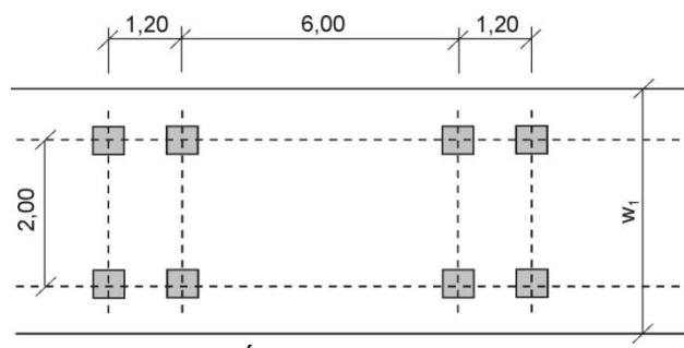
Obrázok G 7.1 Únavový zaťažovací model FLM3
