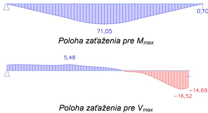
Obrázok G 4.16 Vnútorné sily od vozidla LM3-1, ostatné pruhy –  $M_{Ek}$  (kNm/m),  $V_{Ek}$  (kN/m)
