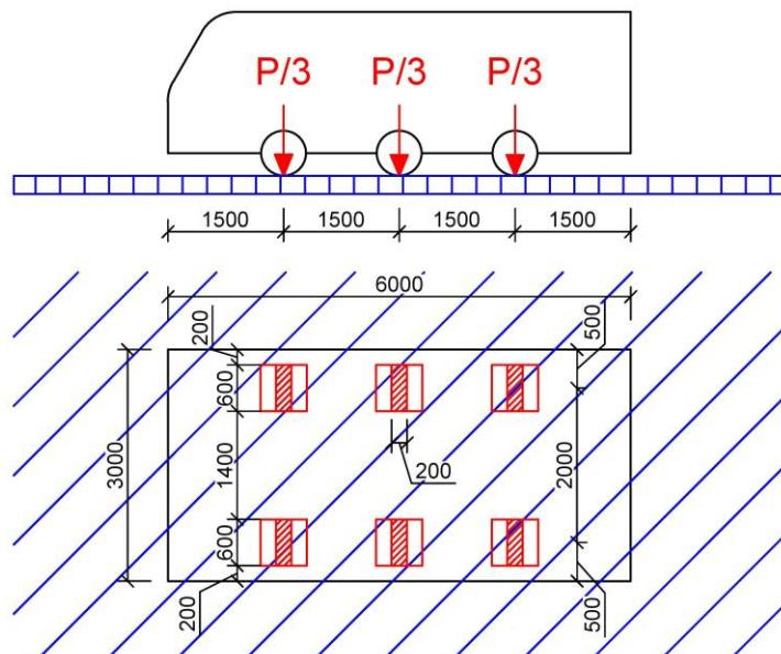
Obrázok H 2.1 Pohyblivé zaťaženie – trojnápravové vozidlo
