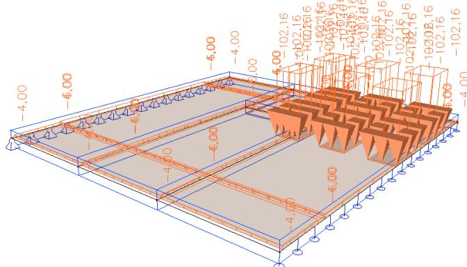
Obrázok H 2.3 Poloha trojnápravového vozidla pre výpočet max. posúvajúcej sily
