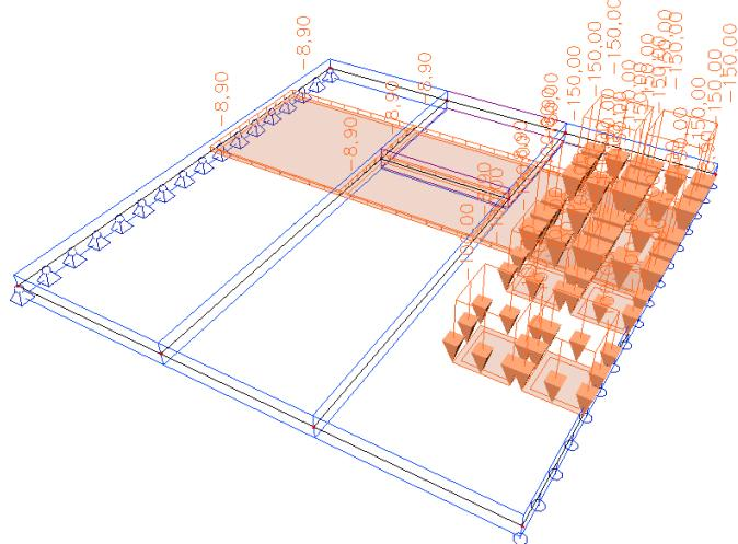
Obrázok G 3.5 Poloha LM1, TS a UDL v 1. pruhu pre výpočet max. posúvajúcej sily
