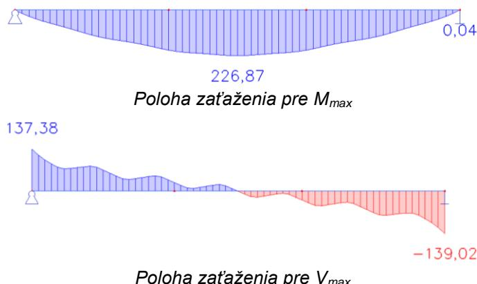
Obrázok G 4.17 Vnútorné sily od vozidla LM3-2 –  $M_{Ek}$  (kNm/m),  $V_{Ek}$  (kN/m)
