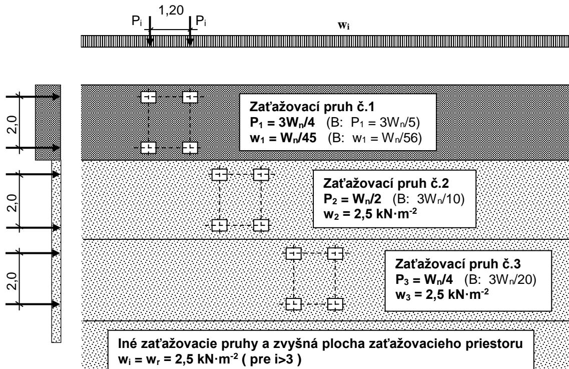
Obrázok 1 – Zaťažovací model normálnej zaťažiteľnosti mostov
