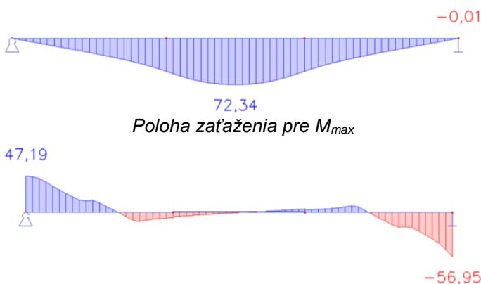
Obrázok G 7.8 Vypočítane hodnoty  $M_{Ek}$  (kNm/m) a  $V_{Ek}$  (kN/m)
