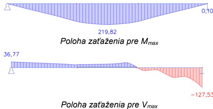
Obrázok H 3.2 Vnútorné sily od trojnápravového vozidla –  $M_{Ek}$  (kNm/m),  $V_{Ek}$  (kN/m)
