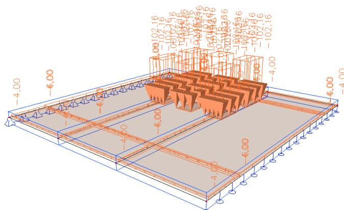
Obrázok H 2.2 Poloha trojnápravového vozidla pre výpočet max. ohybového momentu
