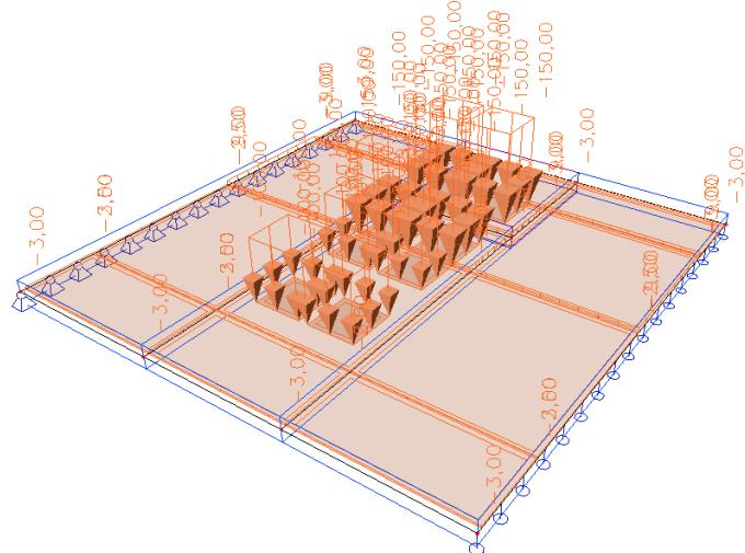
Obrázok H 2.4 Poloha LM1 pre výpočet max. ohybového momentu
