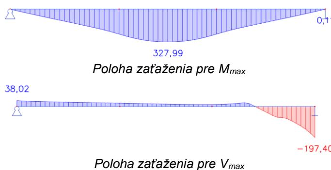
Obrázok H 3.3 Vnútorné sily od LM1 –  $M_{Ek}$  (kNm/m),  $V_{Ek}$  (kN/m)
