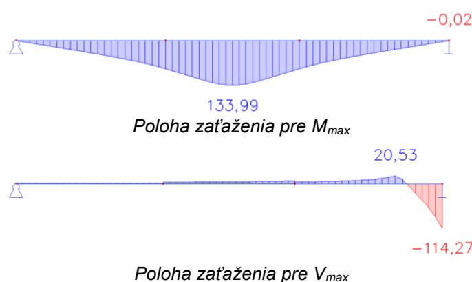
Obrázok G 4.14 Vnútorné sily od vozidla LM2 –  $M_{Ek}$  (kNm/m),  $V_{Ek}$  (kN/m)
