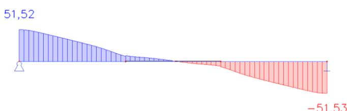
Obrázok G 7.4 Vnútorné sily od vlastnej tiaže dosky, rez pre FLM3 –  $V_{Gok}$  (kNm/m)
