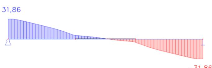
Obrázok G 7.5 Vnútorné sily od ostatného stáleho zaťaženia, rez pre FLM3 –  $V_{Gok}$  (kNm/m)
