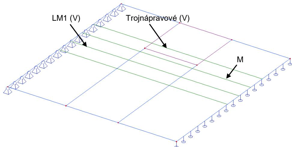
Obrázok H 3.1 Nájdené typické rezy pre jednotlivé zaťažovacie stavy
