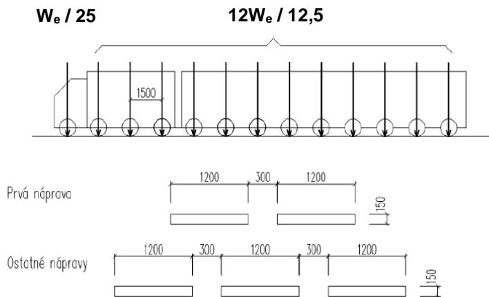
Poznámka:  $W_e$  je tiaž modelu výnimočnej zaťažiteľnosti odvodeného od modelu zvláštneho vozidla 3000/240 kN
