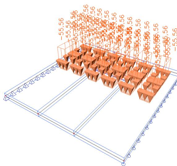
Obrázok G 3.9 Poloha LM3-1, 1. pruh pre výpočet max. ohybového momentu
