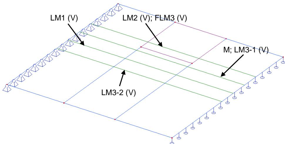
Obrázok G 4.1 Nájdené typické rezy pre jednotlivé zaťažovacie stavy
