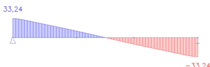
Obrázok G 4.11 Vnútorné sily od ostatného stáleho zaťaženia, rez pre LM3-2 –  $V_{Gok}$  (kN/m)
