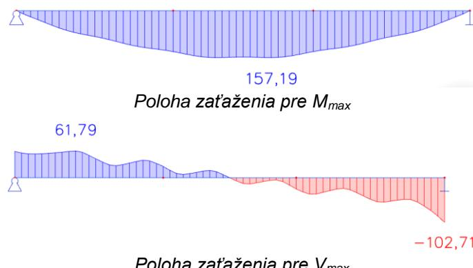
Obrázok G 4.15 Vnútorné sily od vozidla LM3-1, 1. pruh –  $M_{Ek}$  (kNm/m),  $V_{Ek}$  (kN/m)
