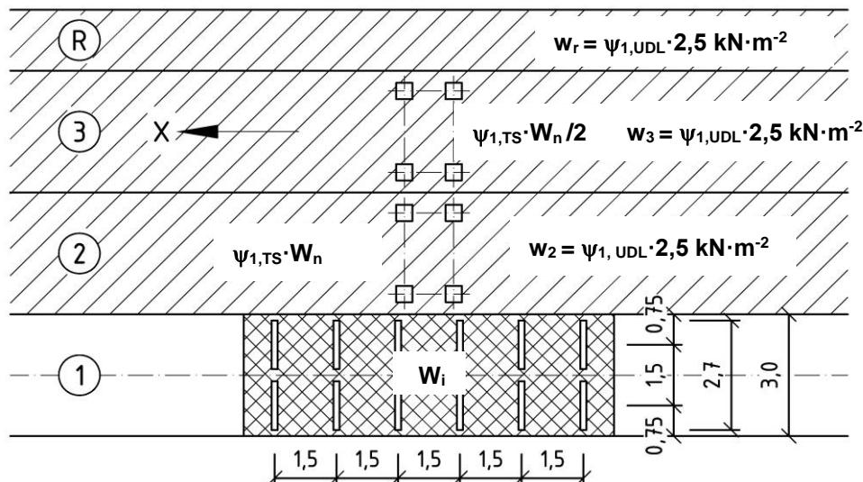
Poznámka:  $W_n$  je tiaž vozidiel (TS) modelu normálnej zaťažiteľnosti v kN,  $w_i$  je hodnota rovnomerného zaťaženia (UDL),  $W_i$  je tiaž zvláštneho vozidla LM3-1 v kN,  $\psi_i$  je súčinítel častej hodnoty
